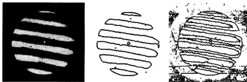
Рис. 15. Обработка интерференционного изображения с целью повышения точности измерения координат полос
