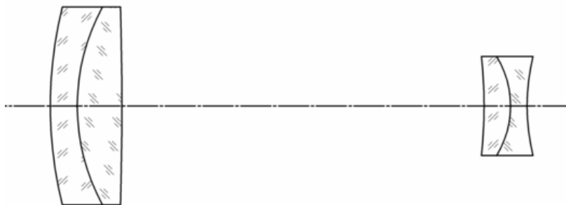
Рис. 4.21 Схема трубки Галилея \Gamma = 2,5 , D = 22 , 2\omega \approx 3^\circ .
