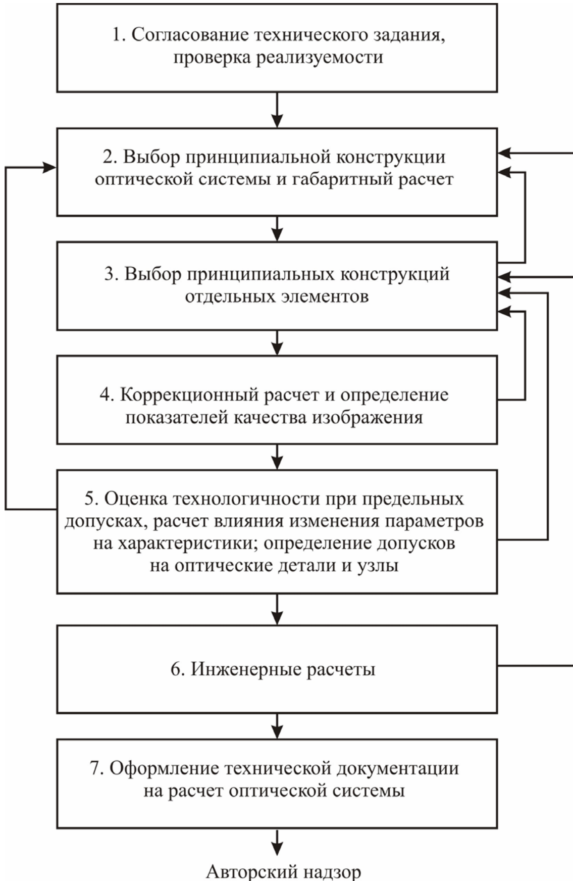
Рис. 2.1 Этапы разработки оптической системы
