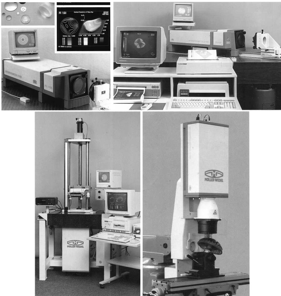
Рис. 54. Разновидности конструктивных решений интерферометра Физо (Фирма Möller-Wedel и ЛОМО)
