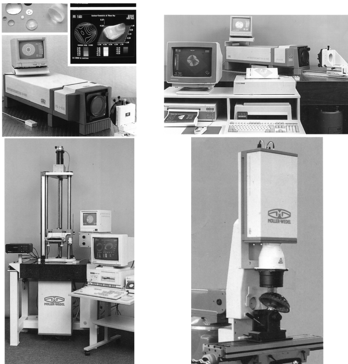
Рис. 56. Разновидности конструктивных решений интерферометра Физо (Фирма Möller-Wedel и ЛОМО)
