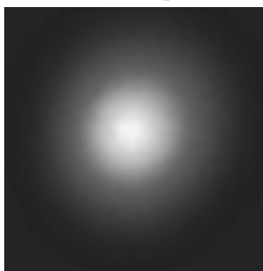
Рис. 52 . Дальнепольное распределение интенсивности на поверхности приемника изображения
