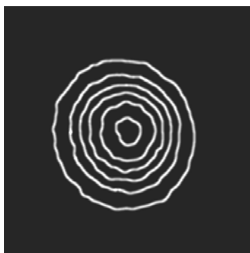
Рис. 53. Изофотограмма экспериментального дифрагированного пятна распределения освещенности в дальнем поле
