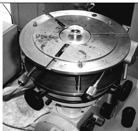
Рис.10. Контроль линзы на интерферометре Физо
