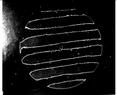
Рис. 5. Метод трансформации распределения интенсивности в интерференционной картине
