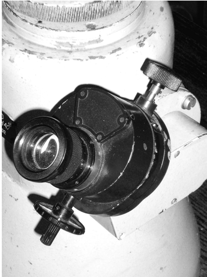
Рис. 10. Отсчетный измерительный микроскоп (в составе кольцевого сферометра)
