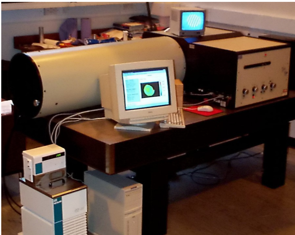
Рис. 56 ИК-интерферометр IR3. Внешний вид
