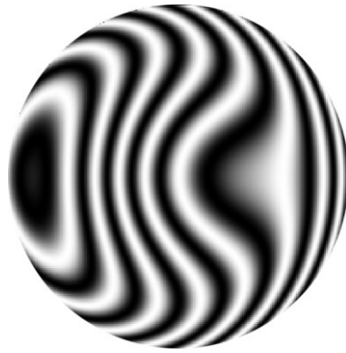
Рис. 21 Вид интерференционной картины при наличии сферической аберрации третьего порядка и наклоне
