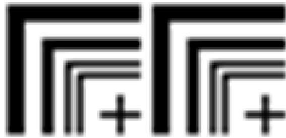
Рисунок 39. Прошедшие пороговую обработку восстановленные изображения, полученные при восстановлении голограмм, синтезированных с помощью старого (слева) и нового (справа) программных комплексов
