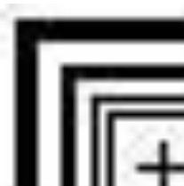
Рисунок. 29 Изображение, восстановленное на основе принципа Гюйгенса – Френеля, после порогового преобразования
