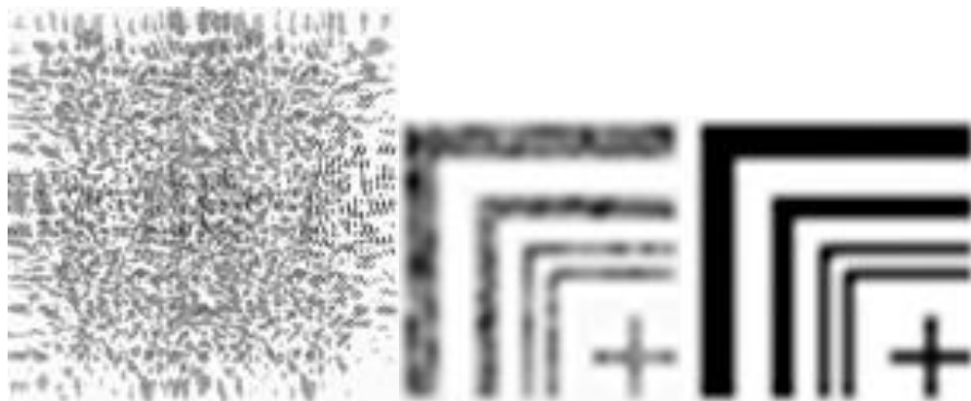
Рисунок 40. Бинаризованная голограмма и ее восстановленные изображения, до и после пороговой обработки, полученные при восстановлении голограмм синтезированных с моделированием диффузной подсветки с диапазоном набега фаз (0 – \pi )
