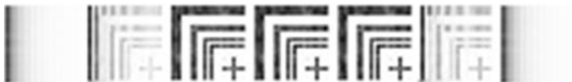
Рисунок 41. Восстановленные изображения, полученные с помощью отражательных рельефно-фазовых голограмм с различной высотой поверхностного рельефа (слева - направо: 0 ; 0,02\lambda ; 0,2\lambda ; 0,25\lambda ; 0,3\lambda ; 0,48\lambda ; 0,5\lambda )
