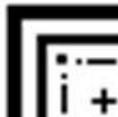
Рисунок 31. Изображение, восстановленное при расстоянии от объекта до голограммы 4 мм на основе принципа Гюйгенса – Френеля при пороговом преобразовании
