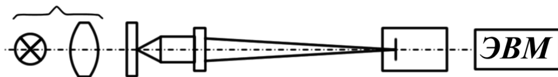
Рис. 9.4. Схема измерения ЧКХ приемной части
