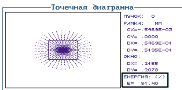
Рис.4.6. Определения диаметра пятна рассеяния.
