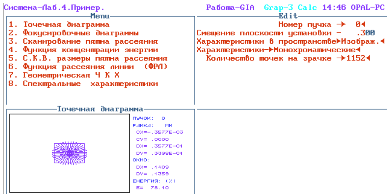
Рис.4.11. Диаметр пятна рассеяния в плоскости наилучшей установки.
