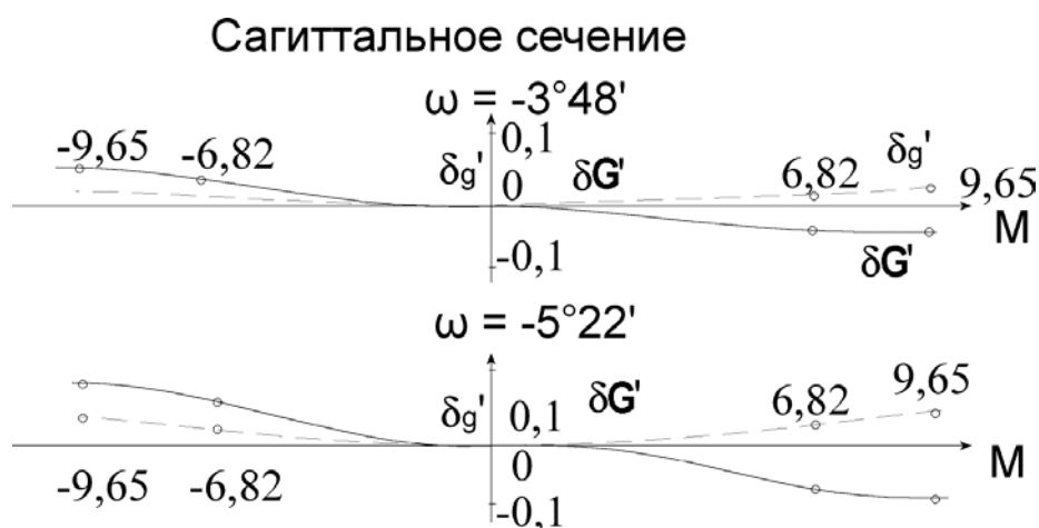
Рисунок 4.4. Пример построения графиков поперечных aberrаций широкого сагиттального пучка лучей.
