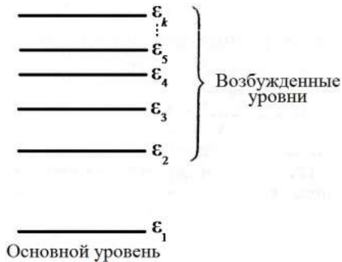
Рис. 7.1. Энергетический спектр атома
