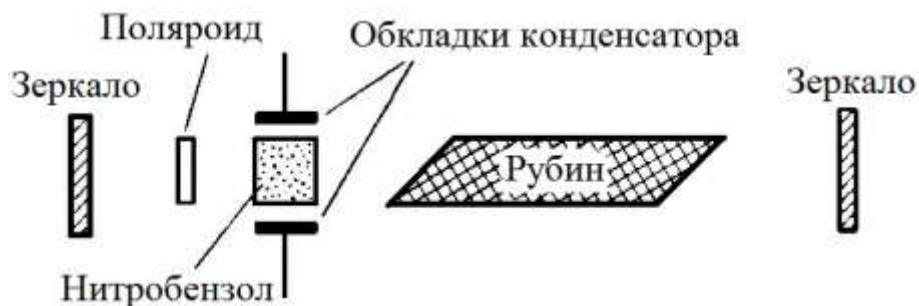
Рис. 7.8. Схема включения и выключения обратной связи с помощью затвора в виде ячейки Керра
