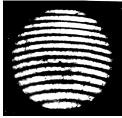
Рис.51. Интерферограмма традиционного пробного стекла с радиусом кривизны 13083 мм, полученная в режиме автоколлимации с помощью голографического пробного стекла с ценой полосы 27,6 мкм
