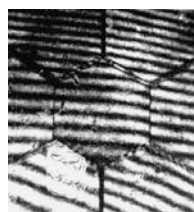
Рис.50. Интерферограммы, полученные при контроле плоского сегментированного зеркала с помощью голографического пробного стекла
